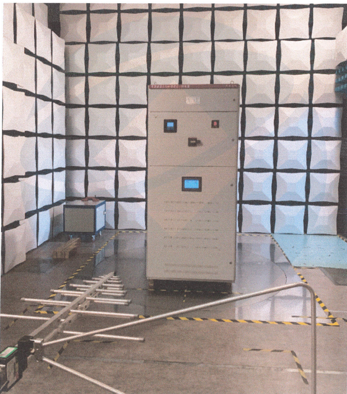
辐射发射试验布置图:
